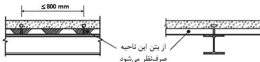
شکل ۱۰-۲-۸-۸: عرشه فولادی که کنگره‌های آن عمود بر محور طولی تیر است
