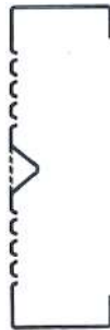
شکل ۲-۲- طولانی کردن مسیر جریان حرارت با ایجاد خم‌های متعدد در جریان پروفیل
