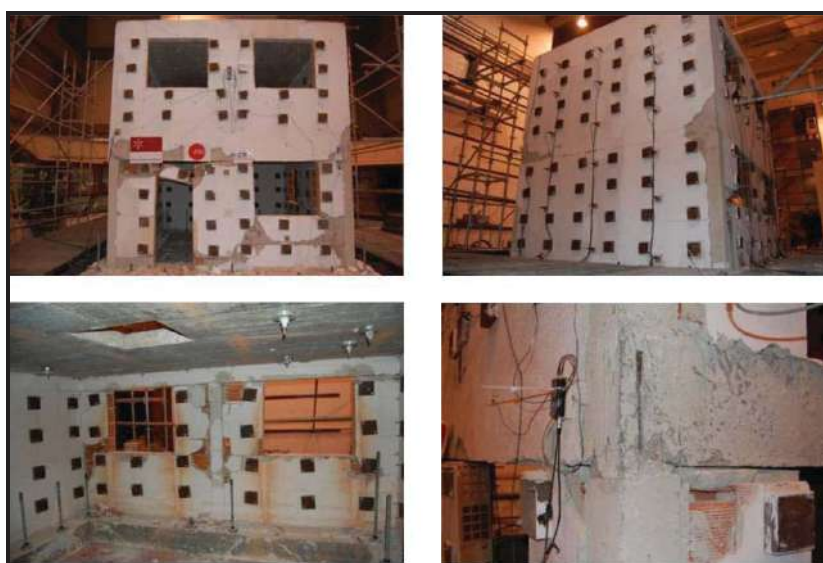
شکل ۱-۱۴- حفظ پایداری خارج از صفحه میانقاب‌های تک لایه به واسطه استفاده از میلگرد بستر [۲۱]
