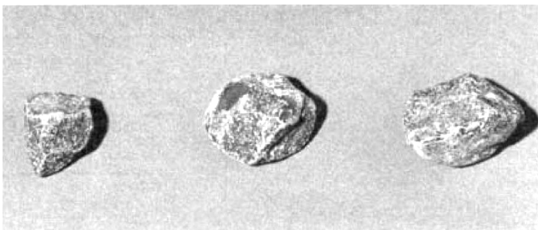
شکل ۴- سنگدانه شکسته (لبه‌های مدور، سطوح ناصاف)
