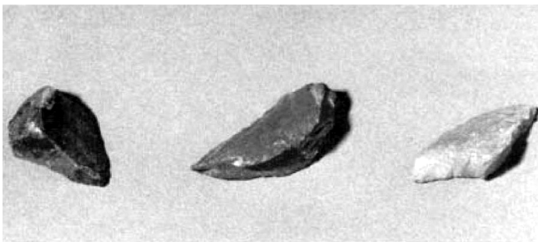
شکل ۳- سنگدانه شکسته (لبه‌های تیز، سطوح صاف)
