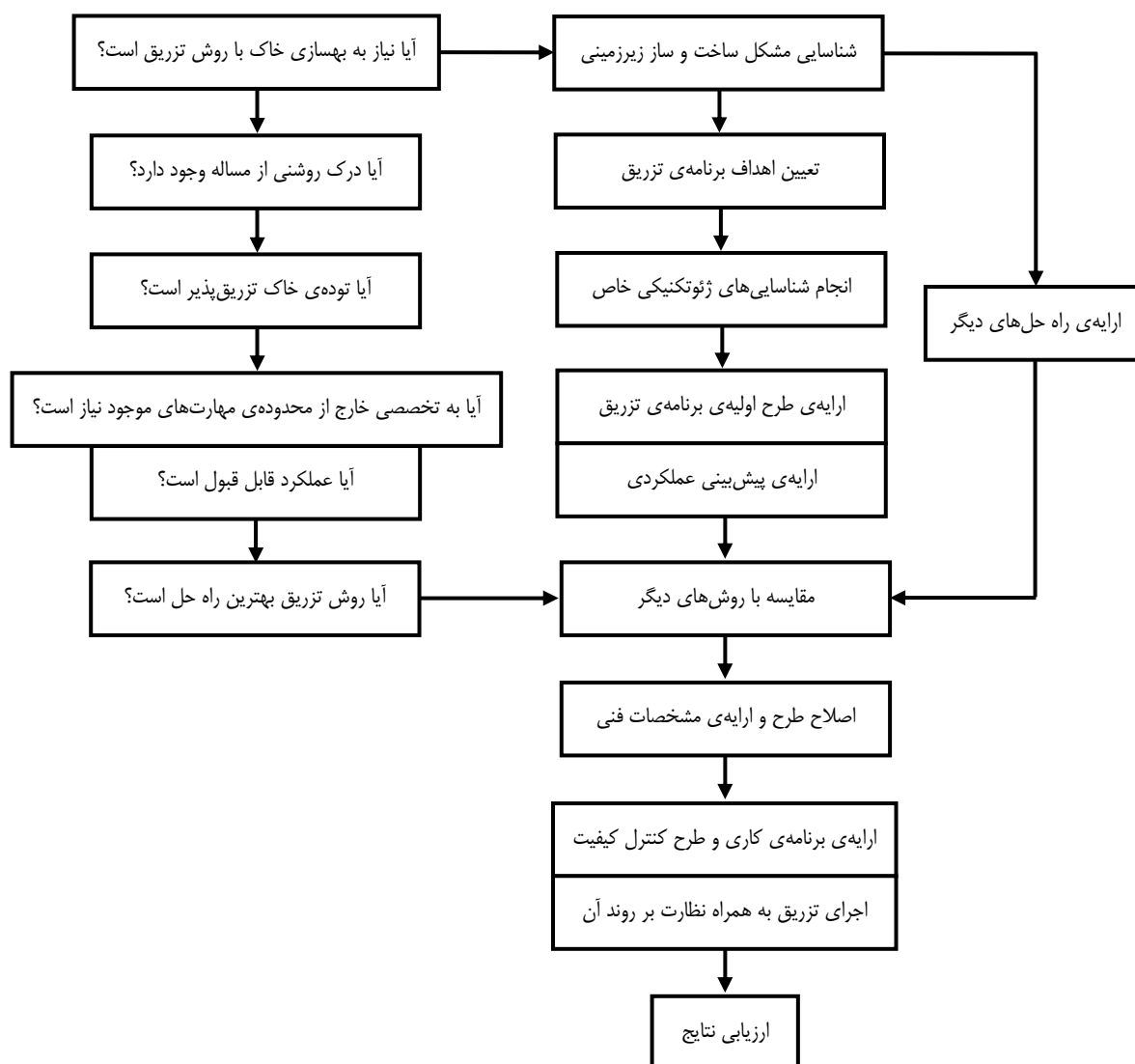
شکل ۸-۴۴- روندنمای گام‌های مختلف روش تزریق
