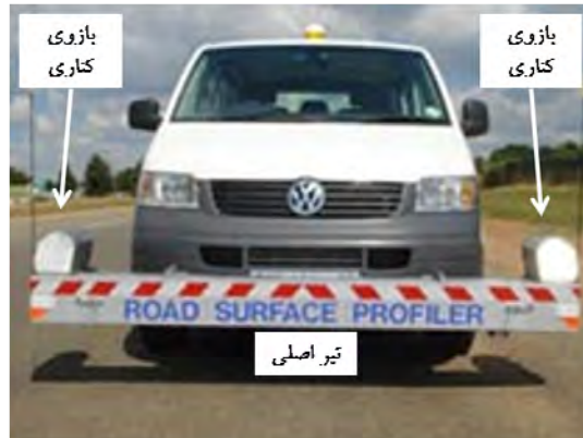
شکل ۷۲- ساختار دستگاه RSP
