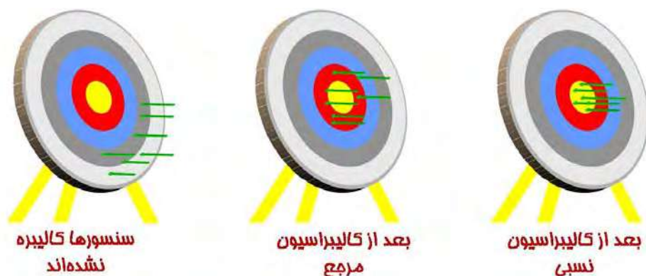
شکل ۲۱- تصویر شماتیک از دقت کالیبراسیون‌ها
