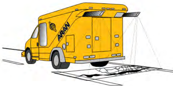
شکل ۷۶- نمایی از دوربین‌های نصب شده در قسمت عقب ون
