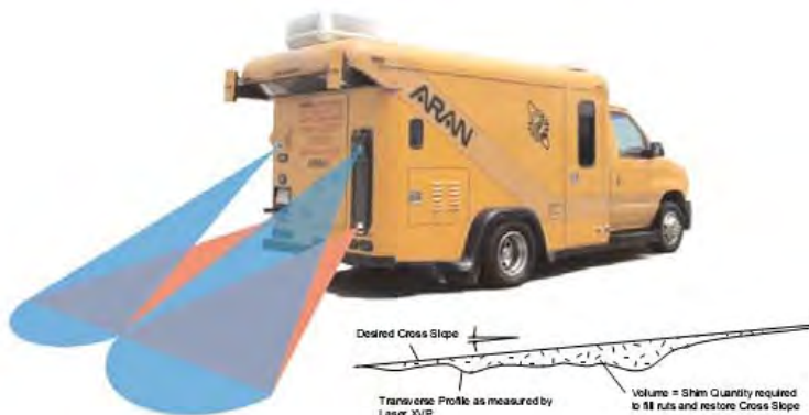
شکل ۷۸- سامانه لیزری در قسمت عقب دستگاه برای تعیین پروفیل عرضی راه
