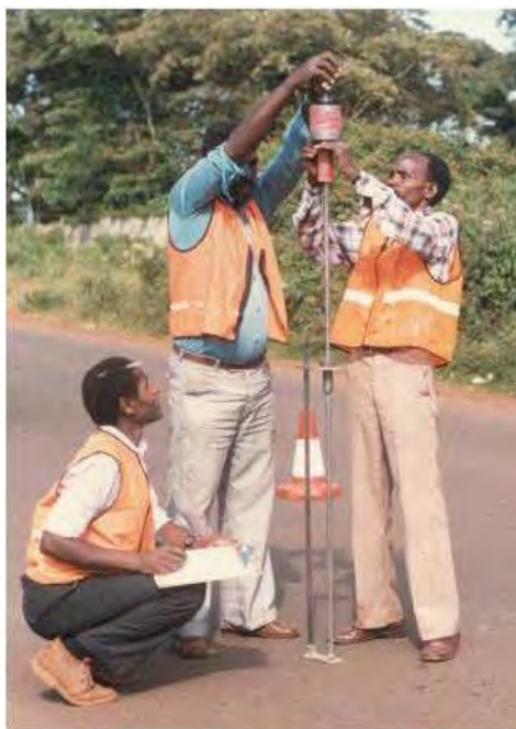
شکل ۶۱- نحوه کارکردن با دستگاه DCP
