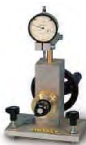
شکل ۶- دستگاه کالیبراسیون تیر بنکلمن
