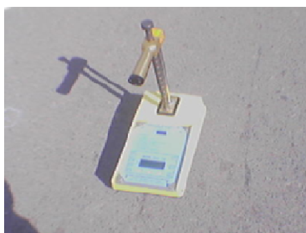
شکل ۴۷- دانسیته‌سنج هسته‌ای هنگام کالیبراسیون
