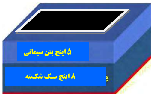
شکل ۲۲- ساختار صفحه ایزوله
